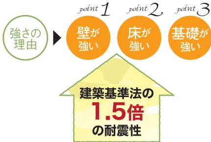
「耐震等級3」は、国土交通省が2000年に定めた、住宅性能表示制度における耐震性能の最高等級です。建築基準法では、極めてまれに(数百年に一度程度)発生する地震による力が定められており、この力に対して倒壊しない程度のを「等級1」としています。
